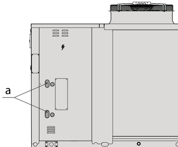
Der Endauslass des Sicherheitsventils muss nach oben gerichtet sein: Im Falle von Austritt erzeugen die Sicherheitsventile einen kegelförmigen Bereich, in dem die für die Entstehung von Bränden erforderliche Konzentration erreicht werden kann.
