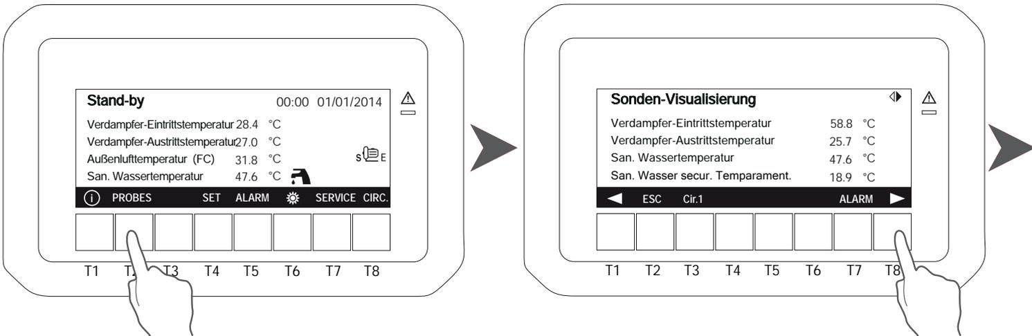
Durch Drücken der Taste T8 sehen Sie die weiteren Temperaturen im Display
