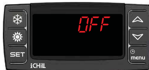
Anzeige im Standby-Modus bei Geräten mit externem Thermostat/ Hygrostat (Option).
