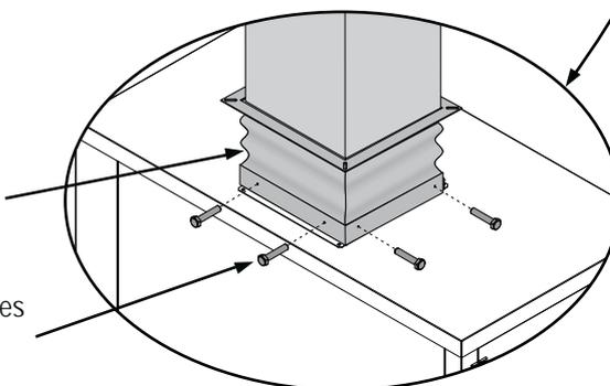
Fijación del conducto a las bocas de impulsión y retorno
