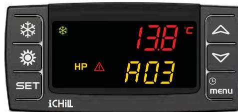
Eine Störung wird im unteren rechten Teil des Displays durch
