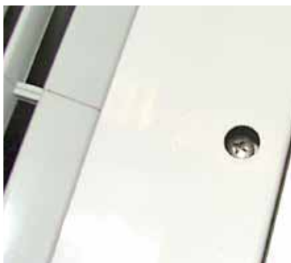
Lösen Sie die Beiden versenkt angebrachten Befestigungsschrauben.
