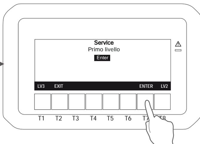
Per accedere a questo menù selezionare **SERVICE**. Il sistema richiede l'inserimento di una password per accedere a diversi livelli di sicurezza; premere **ENTER** per entrare nel primo livello oppure T1 o T8 per accedere ai livelli successivi.
