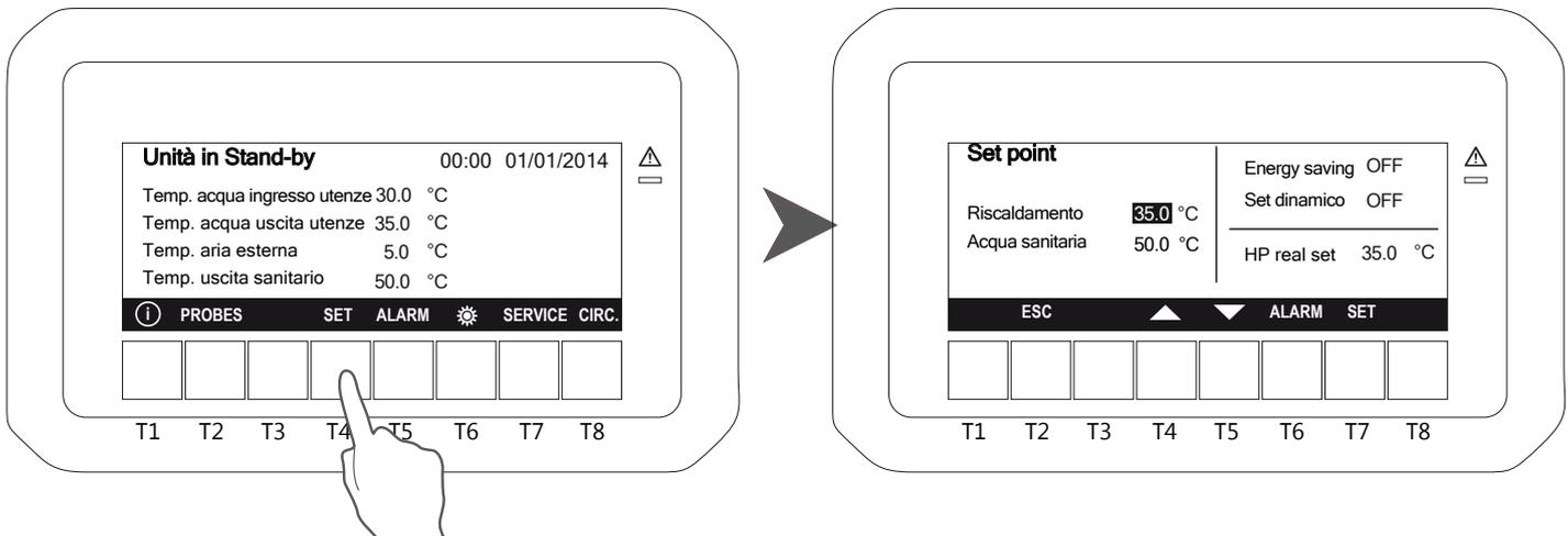
Para modificar los valores posicionar el cursor en el valor deseado con T4; pulsar T7 para seleccionar, el valor empieza a parpadear, luego modificarlo con T4 y T5. Una vez alcanzado el valor deseado debe pulsar nuevamente T7 para confirmar. El cursor se posicionará automáticamente en el siguiente valor, para modificarlo, repetir esta misma operación.
