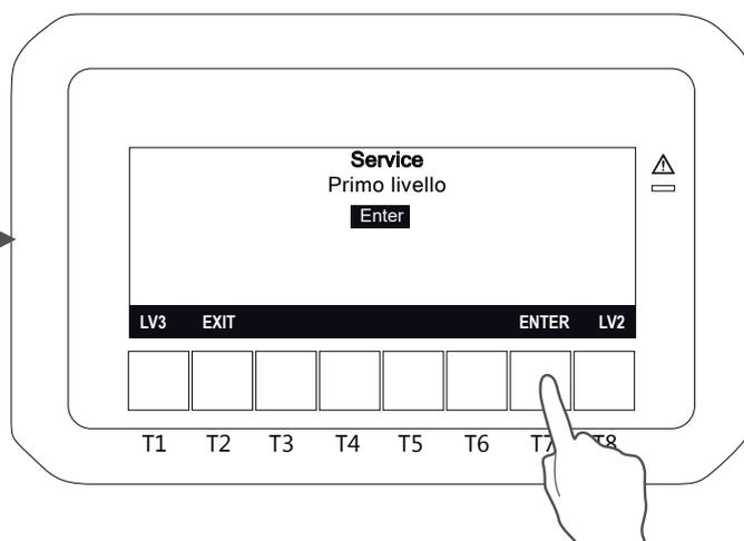
Pour accéder à ce menu sélectionner **SERVICE**. Le système demande un mot de passe pour accéder aux différents niveaux de sécurité; appuyer **ENTER** pour rentrer au premier niveau ou **LV2** ou **LV3** pour accéder aux niveaux suivants.
