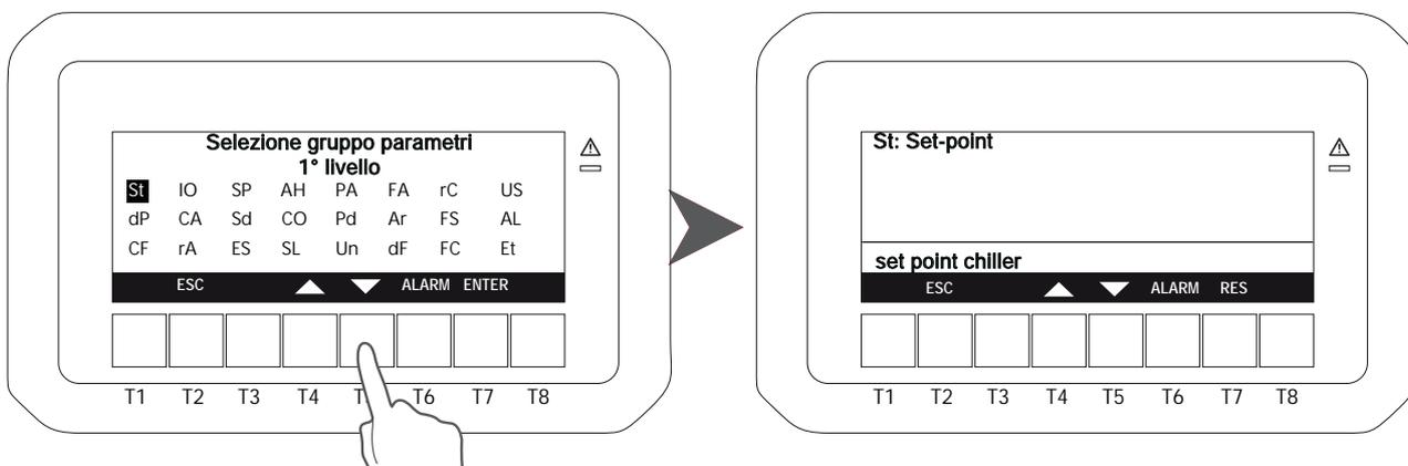
Gruppo parametri Setup (SP) : possibilità di impostazione dell'indirizzo seriale.
