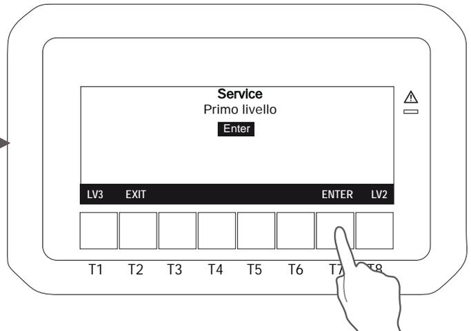
Pour accéder à ce menu sélectionner **SERVICE**. Le système demande un mot de passe pour accéder aux différents niveaux de sécurité; appuyer **ENTER** pour rentrer au premier niveau ou **LV3** ou **LV2** pour accéder aux niveaux suivants.
