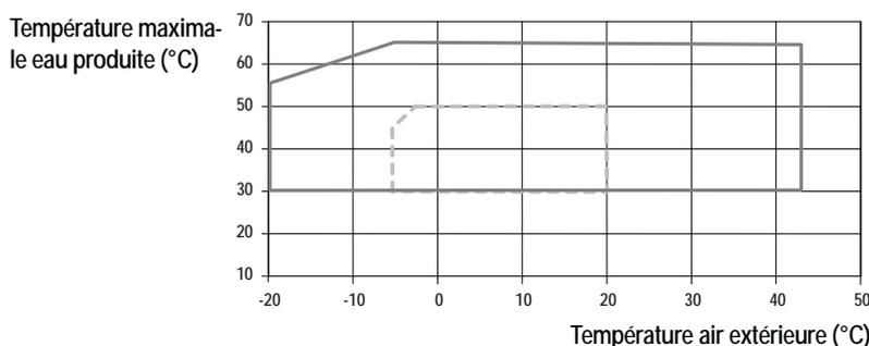
Le graphique ci-dessus montre le champ de travail des compresseurs à injection de vapeur EVI fournis avec les unités LZT; à une température extérieure de -20°C la température de l'eau produite est encore de +52°C; permettant ainsi l'installation de ces unités en toute condition ambiante.
