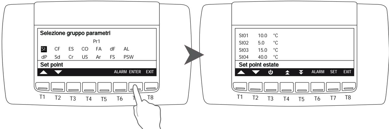
I valori disponibili nel gruppo parametri Set point dinamico (Sd) sono: incremento set point dinamico estivo (Sd01), incremento set point dinamico invernale (Sd02), temperatura aria per set dinamico estivo (Sd03), temperatura aria per set dinamico invernale (Sd04), differenziale aria per set dinamico estivo (Sd05) e differenziale aria per set dinamico invernale (Sd06).
