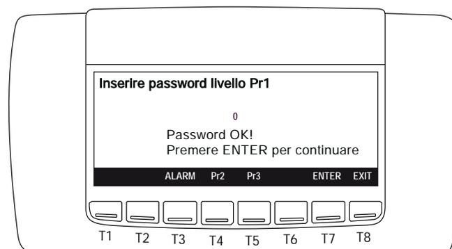
Premendo T1 e T2 è possibile selezionare diversi gruppi di parametri da visualizzare o modificare. Con password di livello 1 è possibile modificare solo i Set Point (St), Set point dinamici (Sd), parametri relativi al circuito sanitario (FS) e parametri per l'impostazione delle fasce orarie (ES) la macchina deve essere in funzione. Premere T7 per entrare nel gruppo di parametri. Gli altri parametri sono accessibili dal personale service solo con password dedicata.
