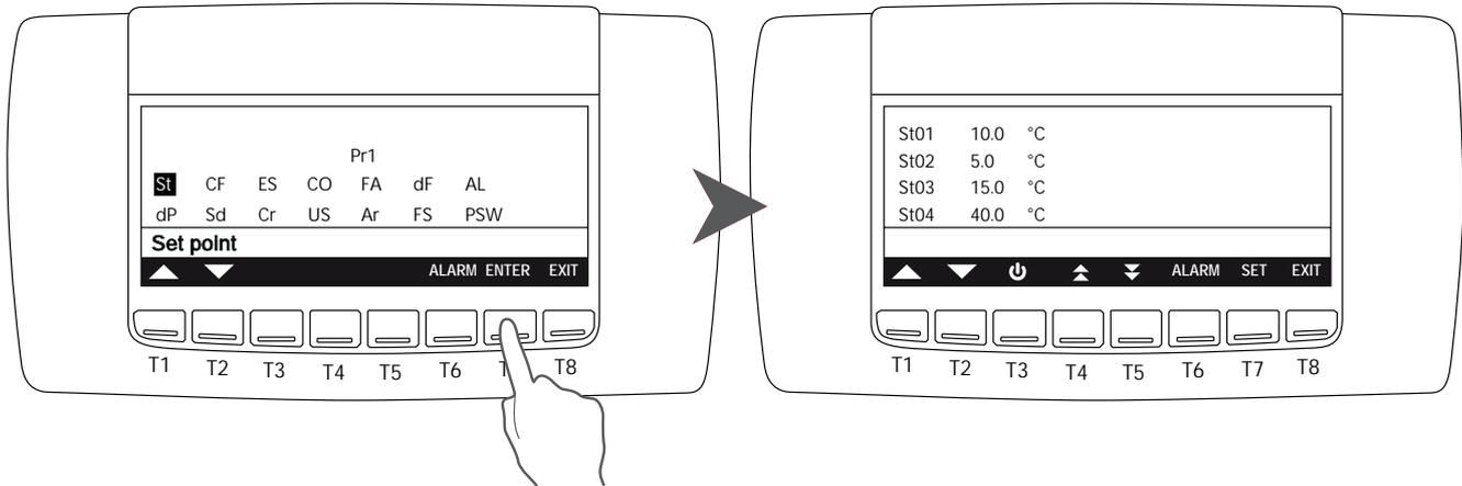
Los valores disponibles en el grupo de parámetros Set point dinámico (Sd) son: incremento set point dinámico de verano (Sd01), incremento set point dinámico de invierno (Sd02), temperatura aire para set dinámico de verano (Sd03), temperatura aire para set dinámico de invierno (Sd04), diferencial aire para set dinámico de verano (Sd05) y diferencial aire para set dinámico de invierno (Sd06).
