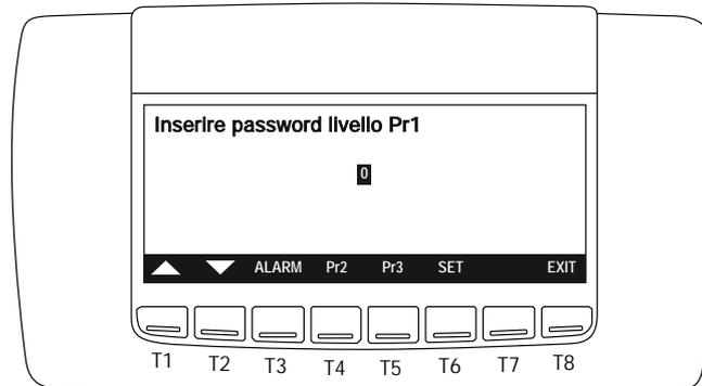
El primer nivel le permite cambiar ciertos parámetros como el verano, el invierno y los puntos de ajuste dinámico. Para acceder a este nivel, pulse T6, con T1 ajustado de 0 a 1, y luego pulse T6 de nuevo para confirmar. Aparecerá la siguiente pantalla:
