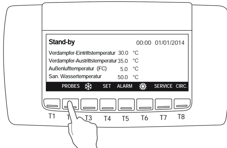
Durch Drücken der Taste
