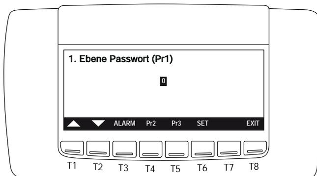
Die erste Ebene erlaubt Ihnen einfachere Parameter zu verstellen wie z. B. Sollwerte beim Heizen und Kühlen und Dynamische Sollwert Verstellung. Drücken Sie die T6 Taste damit die Zahl 0 blinkt nehmen die Pfeil hoch Taste T1 und stellen die Zahl 1 ein bestätigen mit der T6 Taste.
